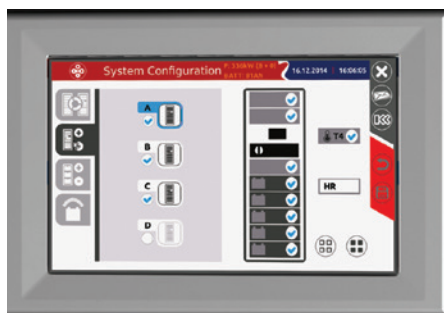
Écran tactile LCD du MPW: configuration et surveillance de l'ASI orientées client
